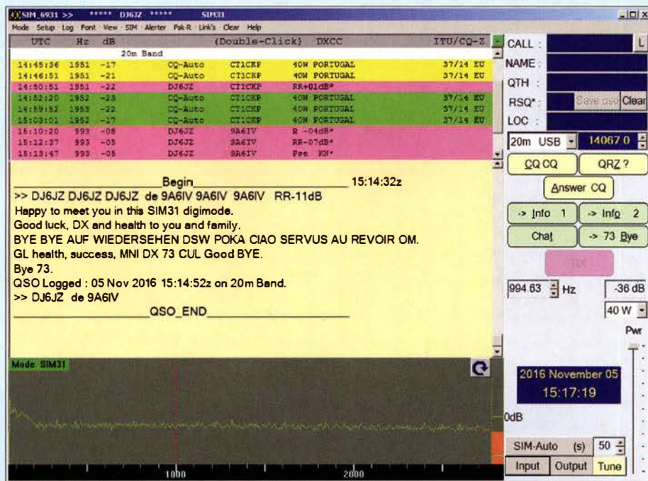
Bild 1: Bedienoberfläche von SIM31; links die Decodierergebnisse aus einem 2,8-kHz-Bereich, darunter die empfangenen Texte auf der eingestellten Frequenz; unten das Spektrum
