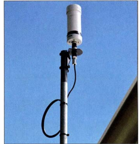
Bild 6: Praxisbeispiel für eine E-Feld-Aktivantenne Foto: VK6YSF
