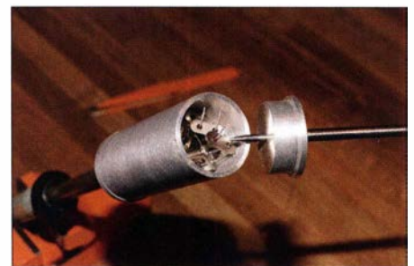
Bild 23: In dem beheizten Aluminiumrohr finden zehn Quarze Platz.
