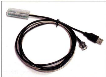
Bild 1: Tastkopf im Gehäuse mit USB-Stromversorgung und koaxialem Messausgang
