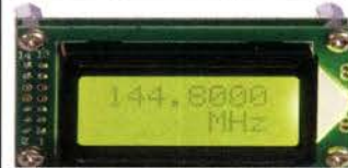
Über Taster programmierbarer Offsetbetrag: „-999,9999“... „0“... „+999,9999“ MHz
