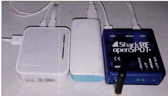
Bild 1: Hier ist der DV-Hotspot Openspot (re.) mit einem drahtlosen Router (li.) verbunden, der über WLAN mit einem DSL-Router o. Ä. verbunden ist. Die Stromversorgung erfolgt über die Powerbank in der Mitte.
