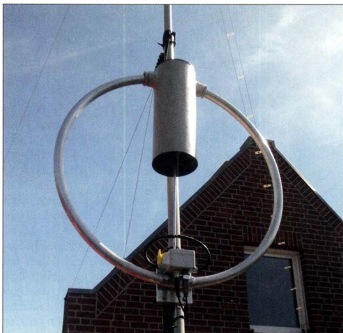
Bild 1: Die AMA-41 auf dem Standrohr neben dem Glasfibrer-Teleskopmast am Carport
