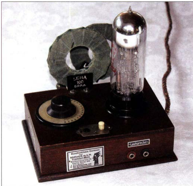
Bild 1: Loewe-Ortsempfänger von 1926; verkauft durch das „Rundfunkhaus Centrum“ in Frankfurt/Main, wie das angebrachte Schild ausweist
